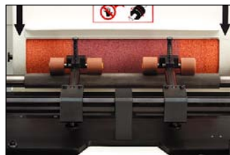
Gleichzeitiges Schleifen zweier mittengeführter Oberwalzen
